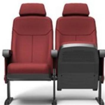
Las butacas TOP presentan un diseño funcional y un sistema de plegado automático, montado sobre dos pies metálicos que tienen integrado un sistema de alojamiento de la rótula, con mecanismo de bloqueo, que recibe el eje de asiento y permite una fácil sustitución sin desmontar la butaca. Las dimensiones son 500 mm de ancho, 770 mm de fondo y 450 mm de alto. Están formados por componentes fácilmente sustituibles y de generosas dimensiones, lo que garantiza su comodidad y versatilidad.
