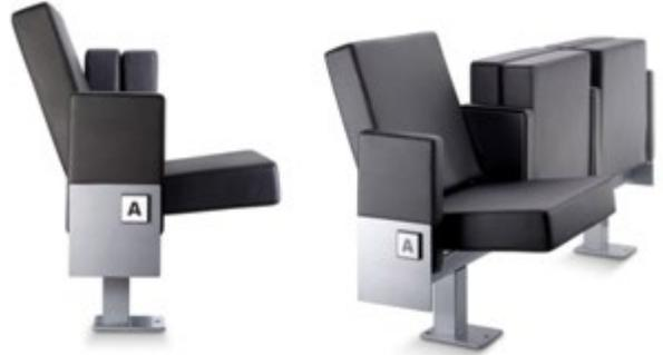
· Gran durabilidad, ya que el asiento está formado por un monobloc compacto configurado por la espuma de poliuretano moldeada en frío que recubre completamente una estructura metálica, compuesta por un marco de tubo curvado, una trama de muelles planos y pivotes de articulación para el giro. El bloque va recubierto con funda de tapicería fácilmente intercambiable, con sistema de cremallera. El respaldo es de las mismas características.
