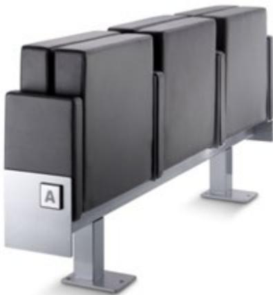
· El retorno del asiento es automático mediante un sistema de doble rotula con muelles y sistema Controlled Soft Rise Technology que evita ruidos o golpes molestos al volver el asiento a su posición de reposo.
