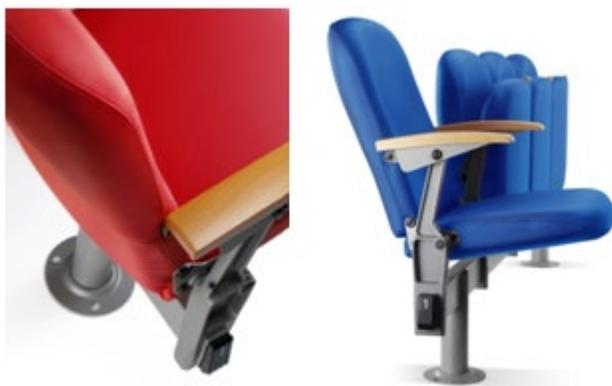
· Les côtés supportant l'assise et le dossier sont en aluminium injecté et sont reliés à une structure tubulaire rectangulaire en acier. Le pied est construit en tube d'acier et se termine par une platine circulaire. Il est fixé au sol à l'aide de chevilles à expansion métalliques.
