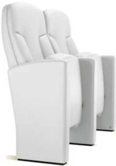
· Siège avec côtés latéraux fixés au sol au moyen d'un support et d'une plaque en acier. Les côtés sont reliés entre eux au moyen d'une structure tubulaire métallique qui, avec les supports latéraux pour la fixation au sol, forment la structure de base de la rangée. Cet ensemble est extrêmement rigide et permet de fixer le reste des composants. Tous les côtés sont entièrement tapissés et rembourrés de mousse PUR flexible qui dote les accoudoirs d'une finition confortable et douce au toucher.
